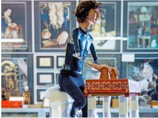
**10 h 00 Mécanisme sophistiqué** «L'escamoteur est l'un des automates dont je m'occupe actuellement. Il sera vêtu façon Caravage, avec de grandes manches bouffantes et des poignets en dentelle. Il bouge la tête et bat régulièrement des paupières. Un mécanisme caché dans la table permet aussi de faire apparaître de manière aléatoire un chiffre différent sur les dés, à chaque fois que le personnage soulève ses gobelets. Il y a en tout 576 possibilités de positionnement des dés.»
