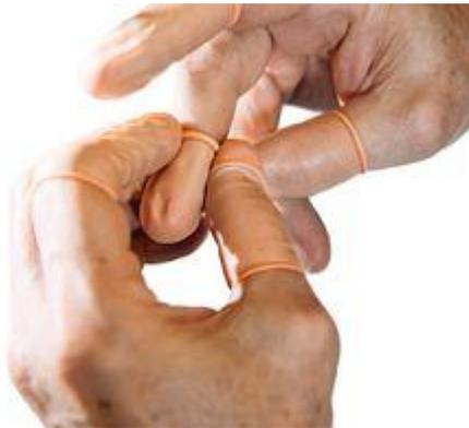
**Objet utile** «Afin d'éviter de laisser des traces sur les automates en métal fin, nous utilisons systématiquement des doigtiers en caoutchouc. En fait, c'est un produit qui est très utilisé par les horlogers. Il nous permet également de ne pas risquer d'oxyder la pièce que nous touchons.»
